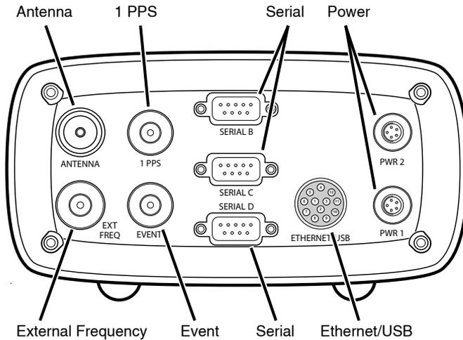
**Figure 1-5. Net-G3A Back Panel Ports**
