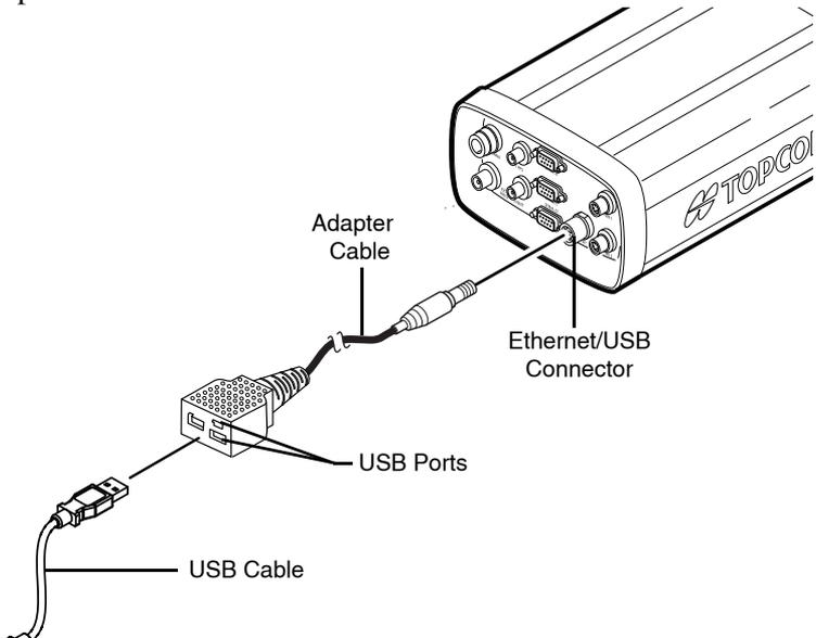
Figure 2-7. Net-G3A USB Ports
