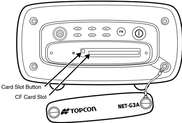
Figure 1-6. Net-G3A CF Card Slot
